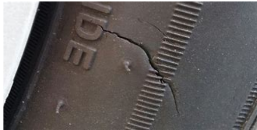
Abbildung 2.40: Ein Riss in einem Autoreifen
